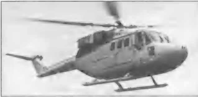
Первый прототип «Линкса» с двигателями Pratt-Уитни PT6B-34.
